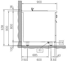
Electrical inlet (power) Equipotential screw
